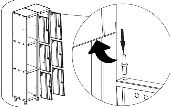
ENCAIXE O PINO ARRUELADO NA PORTA E ENCAIXE A PORTA NO ROUPEIRO GUIANDO PELA FURAÇÃO DAS PRATELEIRAS COM O PINO JA ENCAIXADO NA PORTA CONFORME INDICADO
