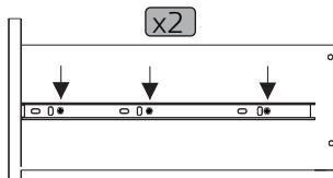
Fixação da parte móvel dos trilhos telescópico nas gavetas com parafuso H.
