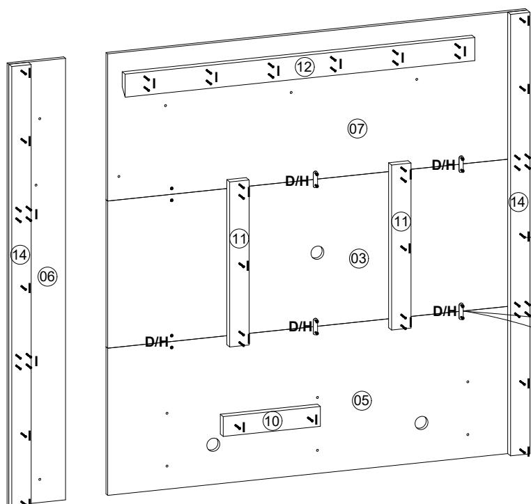
3º - Fixar suportes nos painéis utilizando parafuso cabeça chata 3,5x35 phillips letra **I**. Fixar chapas de união letra **D** nos painéis utilizando o parafuso cabeça chata 3,5x14 phillips letra **G**.
