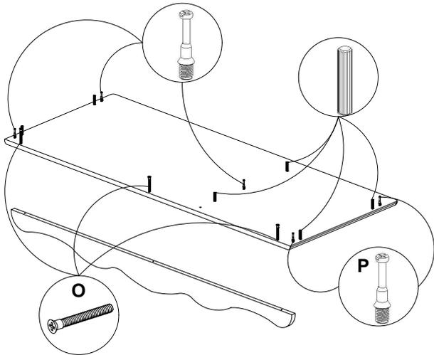
**4º** - Fixar base na lateral direita e divisão com parafuso 5x40 letra O e fixar base no rodape traseiro e rodape frente com parafuso 3,5x25 letra L.
