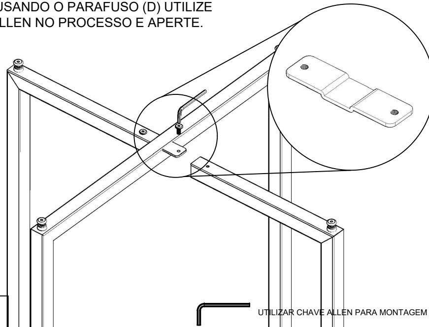
3º) FIXAR A BASE(02) NO TAMPO(01) UTILIZANDO OS PARAFUSOS(C) NOS PRE-FUROS.
