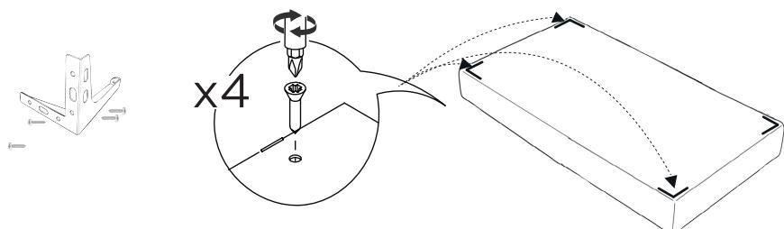
No pé que falta (lado que terá o outro módulo) irá 1 chapa de metal junto. Para fixar coloque um lado da chapa encaixada com o furo do pé de metal, deixando o outro lado da chapa para fora do módulo e, com a chave de fenda, aperte os parafusos em cada pé até que estejam seguros.
