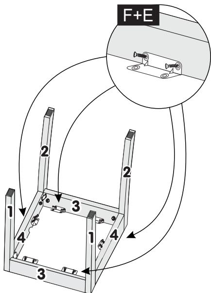
**5º** - TRAVAR AS PEÇAS N.º1 E PEÇA N.º2 COM AS PEÇAS N.º3 E N.º4 UTILIZANDO CHAPA JUNÇÃO 04 FUROS E PARAF. 3,5X14. EM SEGUITA, FIXAR AS SAPATAS DESLIZADORA NAS PEÇAS N.º1 E N.º2.
