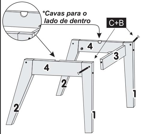
**3º** - UNIR A PEÇA N.º3 COM AS PEÇAS N.º2, UTILIZANDO 1/4X70 CAB. 13mm.
