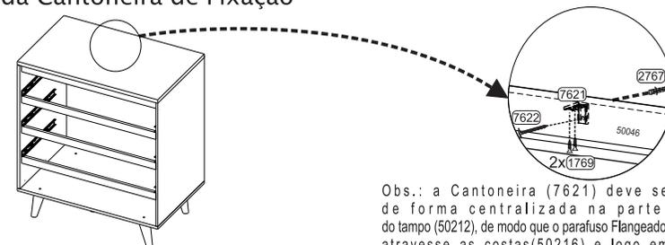
OBS.: a Cantoneira (7621) deve ser fixada de forma centralizada na parte interna do tempo (50212), de modo que o parafuso Flangeado 5x40 (7622) atravesse as costas(50216) e logo em seguida seja fixada na bucha de parede (2767).
