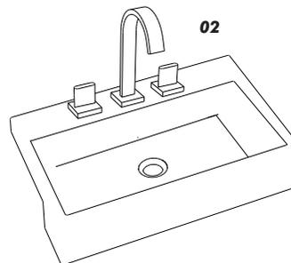
**02.1** Neste caso, deve-se proceder com a abertura dos furos, utilizando broca para mármore, fazendo a furação da parte esmaltada para baixo utilizando água.
