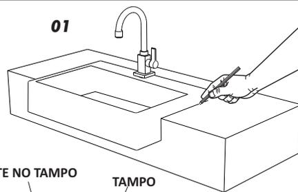
**01** Posicione a sua cuba sobre o tampo na posição que se deseja instalá-la, considerando o ideal posicionamento das torneiras e da saída de esgoto. Marque no tampo onde será efetuado o furo para a saída de esgoto e também o contorno da peça, verificando o esquadro com a parede.
