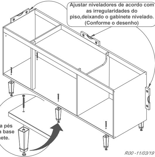
Ajustar niveladores de acordo com as irregularidades do piso, deixando o gabinete nivelado. (Conforme o desenho)
