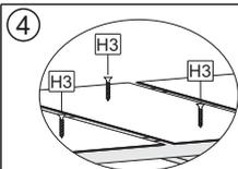
Centralize os reforços na parte de baixo das ripas do estrado e fixe-as com parafusos conforme desenhos acima
