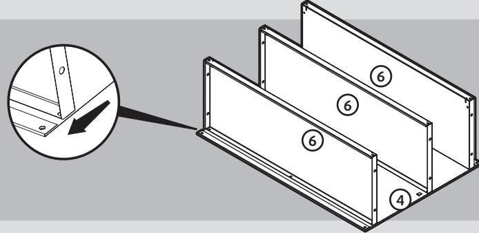
**A** Encaixe as laterais fixando a frente primeiro, finalize colocando os acessórios "E" e "F" nos 4 pontos indicados com ●.
