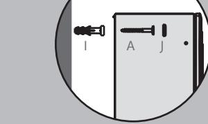
Marque na parede onde irão os furos para fixação dos armários e com a furaideira faça os furos. Coloque as buchas ("I") e fixe o armário com o acessório "A". Para finalizar utilize o acessório "J" para tampar o parafuso.
