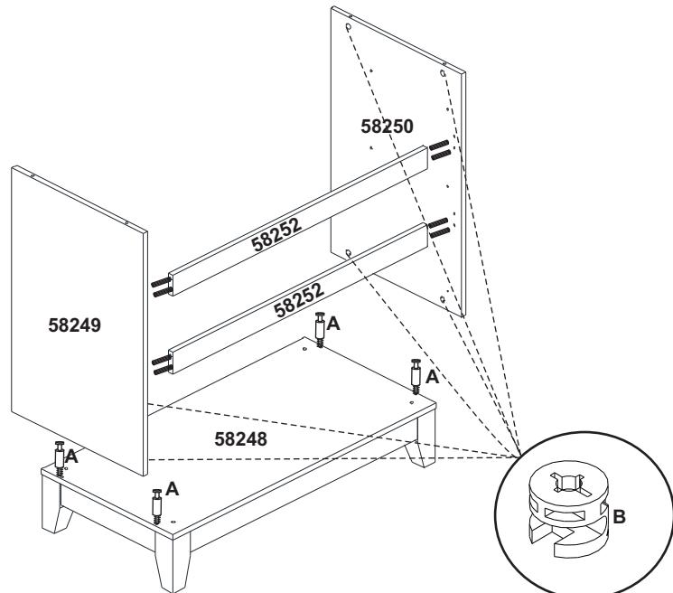
**Passo 3:** 7) Fixar os Parafusos minifix "A" no tampo (58251).
