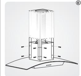
e) Prender as cantoneiras à base da coifa utilizando os parafusos e aruelas do kit de fixação. Será necessário o trabalho de duas pessoas para a união das duas partes.
