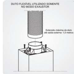
c) Fixar a conexão para o duto flexível com os parafusos e encaixar o duto flexível (no modo exaustor).
