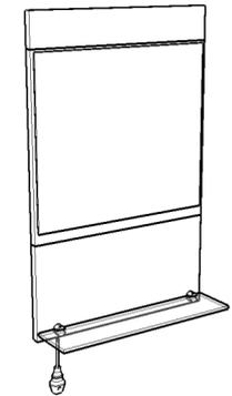
10.1: Encaixe o vidro ( P ) nos pitões ( Q ) e aperte com uma chave de fenda.
