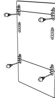
7.1: Fixe a a moldura menor na parte superior com as chapas retas ( O ) usando os parafusos ( N )
