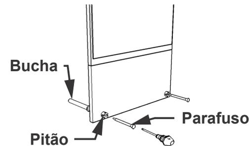
9.1: Através dos pré furos da moldura maior, fure a parede e usando a bucha ( L ) fixe os parafusos ( M ) através do pitões ( Q )
