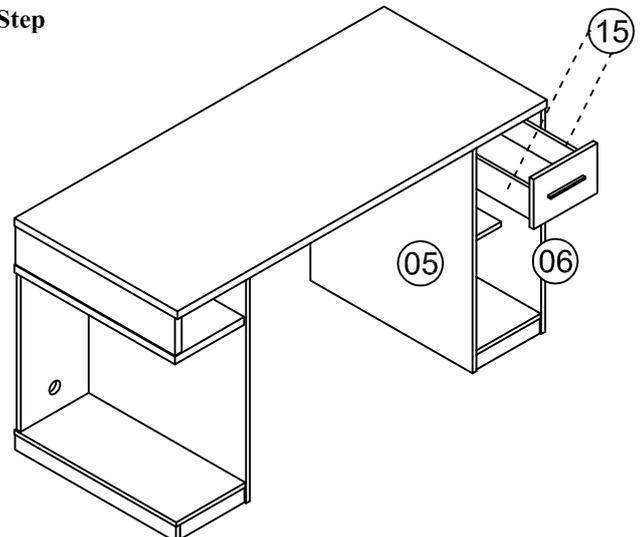
Fixe as corrediças nas peças 05,06 e 15 com parafuso 3,5 x 12. Encaixe a gaveta.
