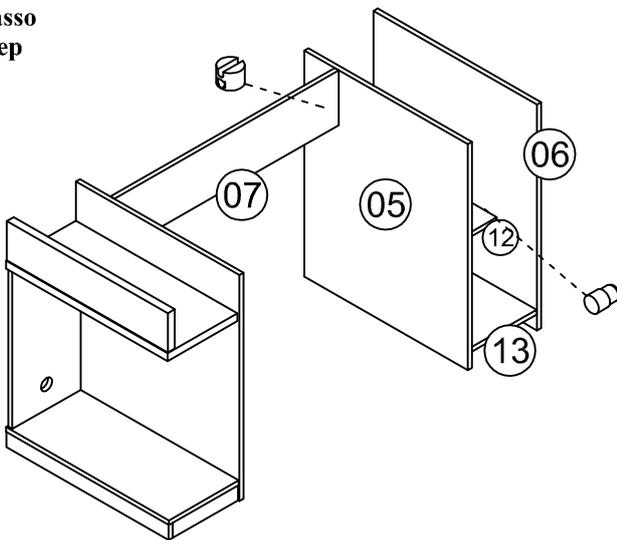
Fixe a peça 05 na peça 07 com porca cilindrica e parafuso 4,5 x 50. Depois fixe a peça 13 nas peças 05 e 06 com cavilha e parafuso 4,5 x 50. Por ultimo, fixe a peça 12 com suporte de prateleira.
