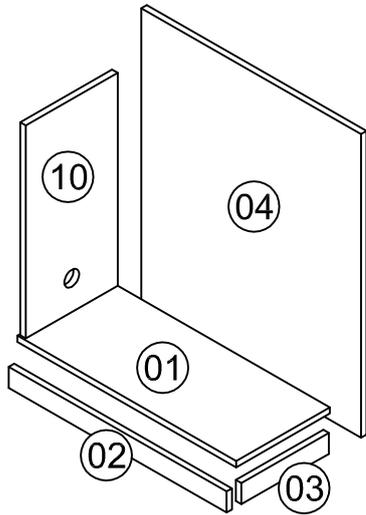
Fixe as peças 02 e 03 na peça 01 com mini-fix, cantoneira e parafuso 4,0 x 14. Fixe a peça 04 na peça 01 com cavilha e parafuso 4,5 x 50. Fixe a peça 10 com cavila. Depois fixe as sapatas 15 x 36 x 06 nas peças 02 e 03 com prego 13 x 15.
