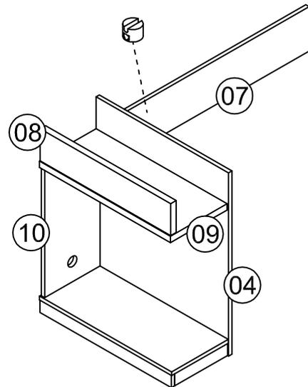
Fixe a peça 09 na peça 04 com cavilha e parafuso 4,5 x 50. Depois fixe a peça 08 na peça 08 com cavilha e parafuso 5,0 x 60. Por ultimo, fixe a peça 07 na peça 04 com porca cilindrica e parafuso 4,5 x 50.
