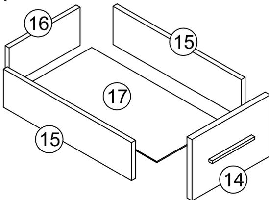
Fixe as peças 15 na peça 16 com cavilha e mini-fix 12 x 11. Encaixe o fundo 17 nos rasgos. Depois fixe as peças 15 na peça 14 com cavilha e mini-fix 12 x 11. o ultimo fixe o puxador com parafuso 3,5 x 25.
