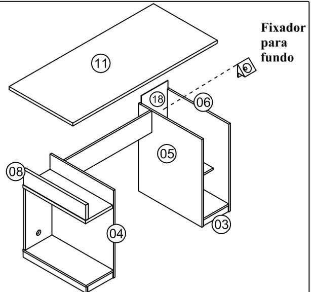
Fixe a peça 03 com cantoneira e parafuso 4,0 x 14. Encaixe o fundo nos rasgos das peças 05 e 06. Fixe a peça 11 com cavilha e mini-fix 15 x 12. Fixe o fixador de fundo com parafuso 3,5 x 12.
