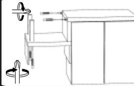
1.6 - Parafuse os prolongadores ( C ) com os parafusos ( G ) e os pitões ( E ) com os parafusos ( i ).
