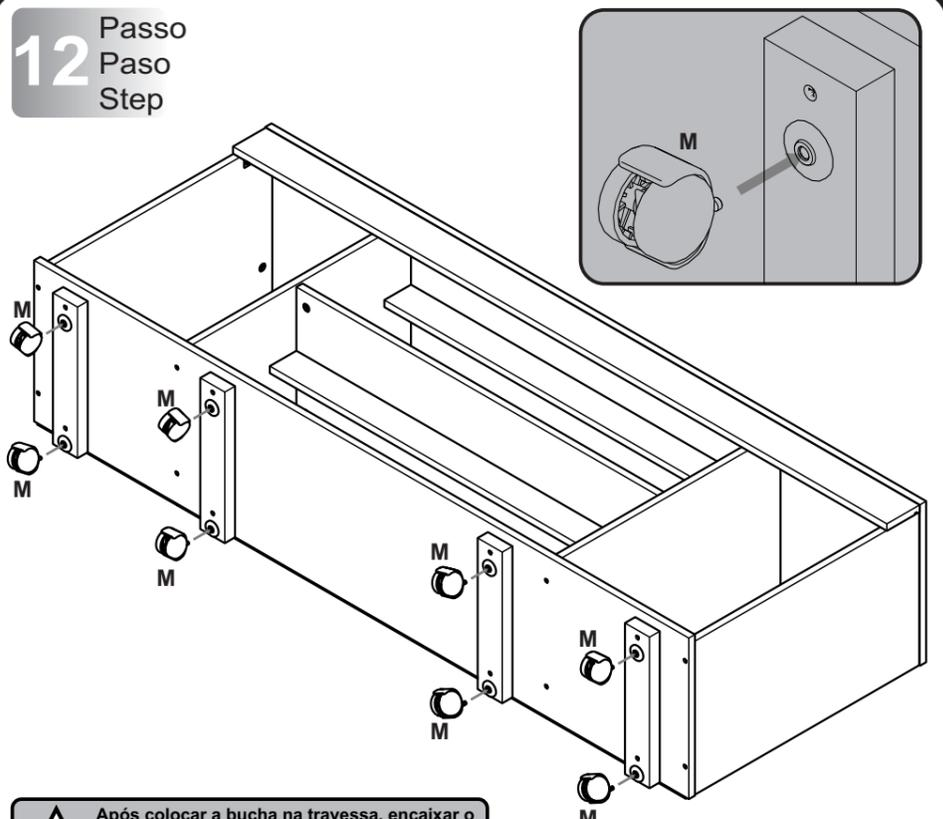
⚠ Após colocar a bucha na travessa, encaixar o rodízio usando uma determinada força até dar um "CLICK".
