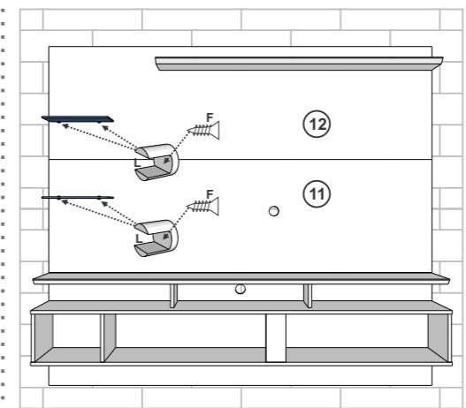
Pendurar os painéis 11 e 12 na parede nas cunhas ja fixadas. Fixar os Suportes das prateleiras de vidro com Parafuso 3,5x12.
