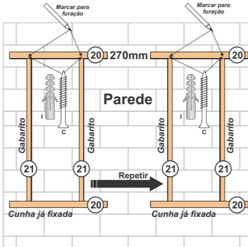
Encostar os 2 gabaritos 21 na cunha 20 já fixada na parede, colocar a outra cunha encostada na parte superior do gabarito e marcar a parede para colocar a bucha e fixar a cunha com Parafuso 6x80. Repetir para a cunha fixada do lado direito.
