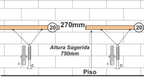
Fixar as cunhas de fixação 20 na parede com Parafuso 6x80 e Bucha 10. Deixar uma distância de 270mm entre as cunhas.
