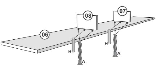
Fixar as 07 e 08 na peça 06 com Cavilha e Parafuso 5x50.
