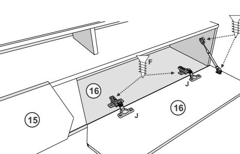
Fixar as portas 15 e 16 na peça 01 com dobradiças e Parafuso 3,5x12. Fixar a porta 16 na peça 05 e a porta 15 na peça 02 com Pistão e Parafuso 3,5x12.
