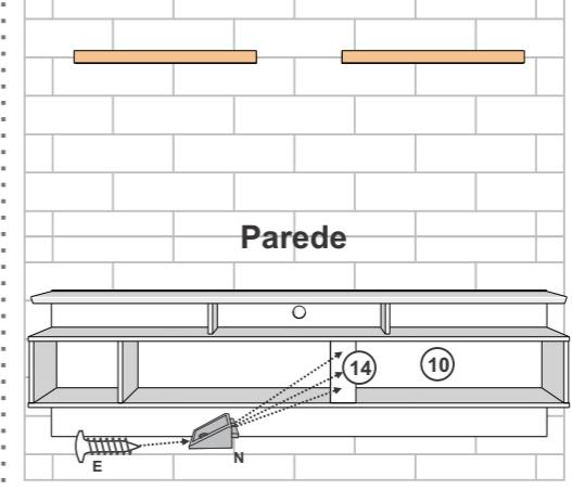
Fixar a peça 14 na peça 04 com Suporte angular e Parafuso 3,5x12 flangeado. Pendurar o painel 10 na cunha fixada na parede.
