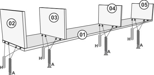
Fixar as peças 02, 03, 04 e 05 na peça 01 com Cavilha e Parafuso 5x50.
