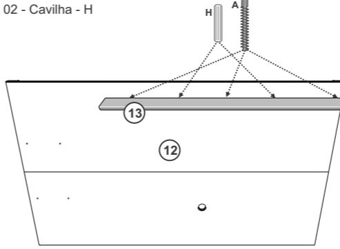
Fixar a peça 13 na peça 12 com Parafuso 5x50 e Cavilha.
