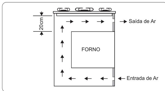
Se o fogão for embutido em móveis com tampos de granito, mármore e aço inóx observe o nicho adequado para cada modelo conforme desenho abaixo.
