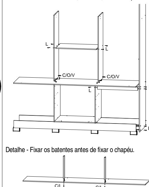
Passo 5 - Fixar lateral esquerda, travessa, chapeú com batentes e tampo
