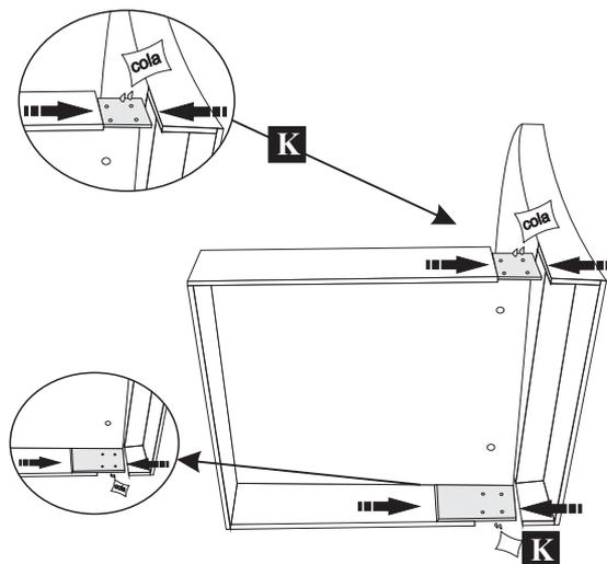
UNIR O ASSENTO AO ENCOSTO, UTILIZANDO CHAVE ZETA + PARAFUROS 07X40 CAB.17mm. LOGO APÓS FIXAR A CHAPA(6mm) DO ASSENTO AO ENCOSTO, UTILIZANDO PARAFUSOS 3,5X16.
