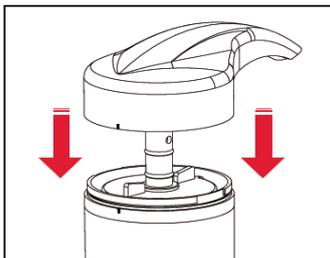
Em seguida coloque a tampa com os pontos alinhados e aperte até se unirem
