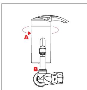
Desenrosque o filtro (A) do registro e a bica (B) da torneira se necessário para facilitar a instalação.
