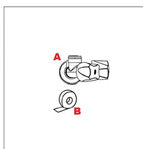
Instale o corpo do produto (A) na parede utilizando a Fita Veda Rosca Durín (B). Após o corpo instalado, recoloque o copo do refil e bica da torneira.
