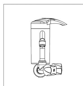
Com o produto montado e instalado no local desejado, torne a ligar o registro geral de água. Ao utilizar pela primeira vez o Filtro, deixe correr 30 litros de água até ficar cristalina para que o elemento filtrante libere o pó do carvão.
