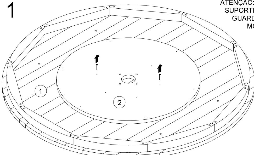
ATENÇÃO: SOLTE OS PARAFUSOS DO SUPORTE DO TAMPO (PEÇA Nº 2) E GUARDE PARA SER USADO NA MONTAGEM DA MESA.
