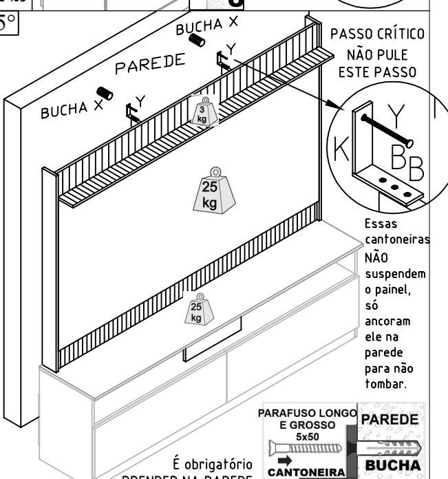
**É obrigatório o uso dos quatro UNIDORES METÁLICOS, ele é fixado com 2 parafusos B.**
