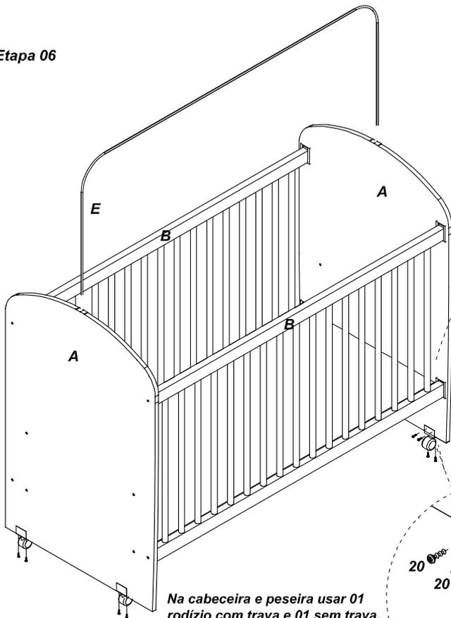
Na cabeceira e pesseira usar 01 rodízio com trava e 01 sem trava. Montar o rodízio próximo a parte externa da peça para aumentar a estabilidade do berço.
