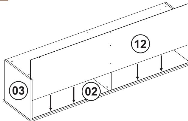
**5** Coloque e aperte os parafusos (F) na peça nº 12.
