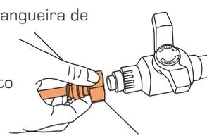
3 Conecte a outra extremidade da mangueira de instalação na entrada de água localizada na parte traseira do refrigerador. Certifique-se de que a conexão foi encaixada até o fim.
