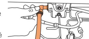
4 Abra a torneira (verifique se existe algum vazamento ou gotejamento de água em algum ponto da instalação). Em caso de vazamento confira se os encaixes da mangueira foram feitos corretamente.
