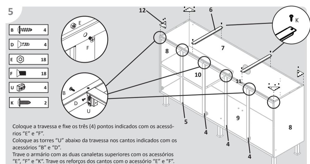
Coloque a travessa e fixe os três (4) pontos indicados com os acessórios "E" e "F".
