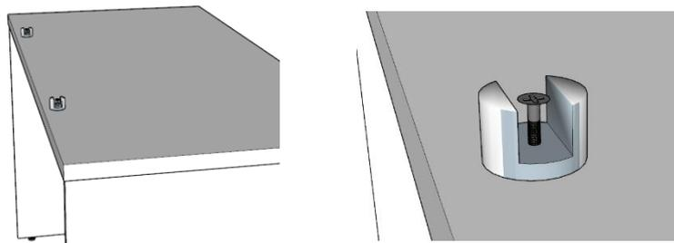
EM SEGUIDA, FIXE O SUPORTE U "T2" UTILIZANDO O PARAFUSO 4,5X25 "P2".
