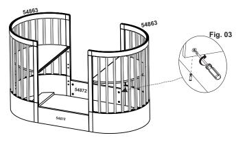
Passo 4: 5) Fixar as grades (54873), utilizando os parafusos 1/4 X 65 mm alemm "A".
