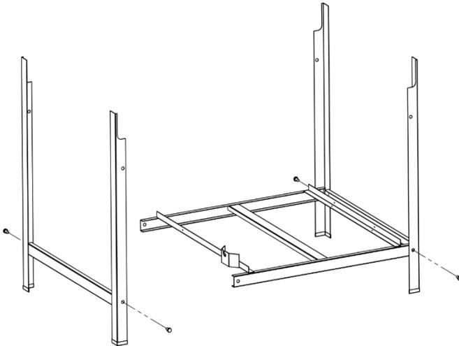
2. Em seguida coloque o quadro sobre a base e aparafuse:
