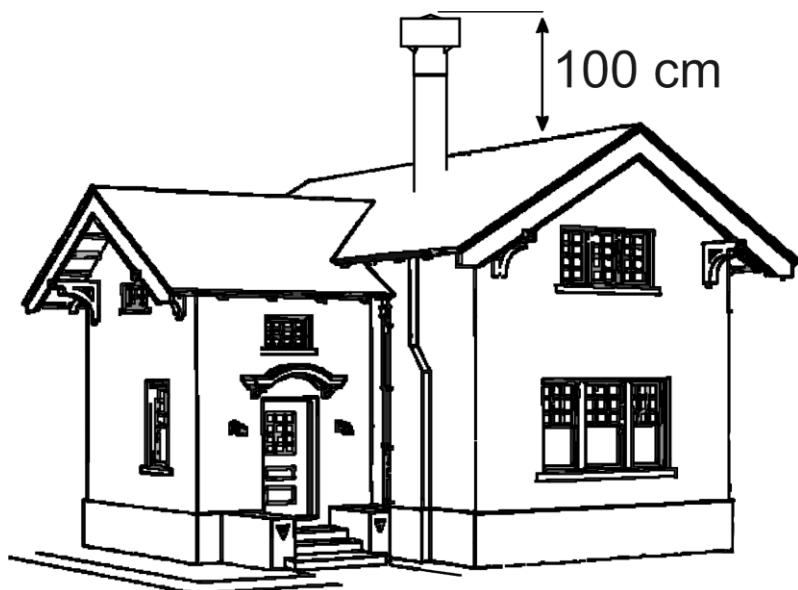
O Chapéu deve ser instalado com no mínimo 1 metro acima do ponto mais alto do telhado.
