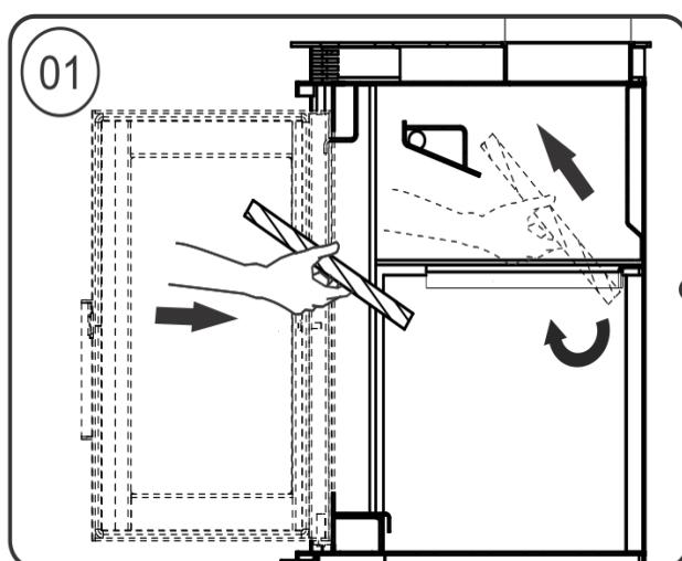
Segure a plaqueta cerâmica, já dentro do fogão, inclinando-o para frente (01) até que encoste no fundo da caixa de fogo, mantendo uma linha diagonal movimento para cima (02), buscando o apoio superior.
