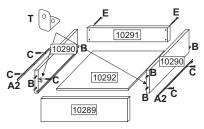
Gavetas - Parafusar as laterais de gaveta ao lenço da gaveta com o parafuso (E); encaixar o fundo no rasgo e fixe a frente com a cavilha (B) e cantoneira (T); a corrediça (A2) deve ser parafusada na lateral (10290) com o parafuso (C) na posição horizontal.
