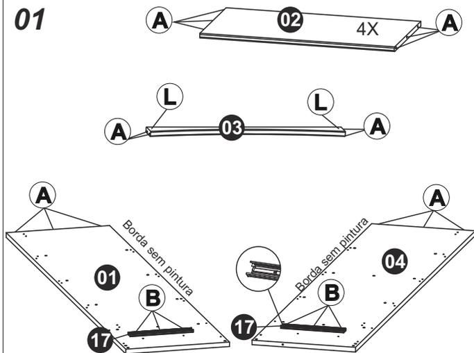
> Montar as cavilhas conforme indicado;
