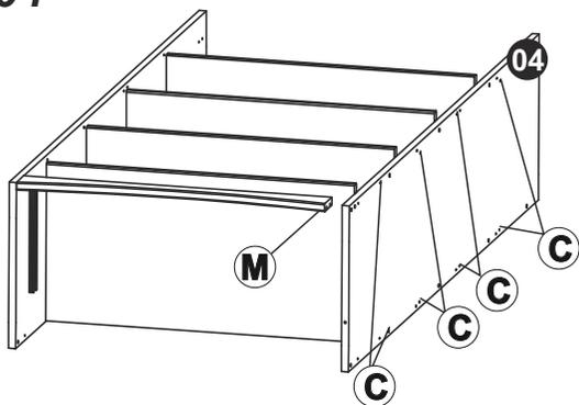
> Montar as peça 05 utilizando a ferragem indicada.
