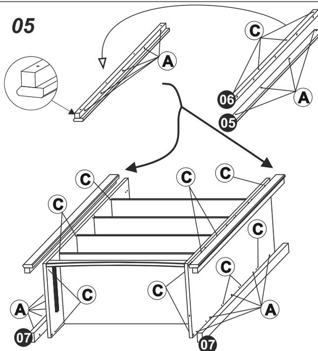
> Montar as peças 06 e 07, observando detalhe;
