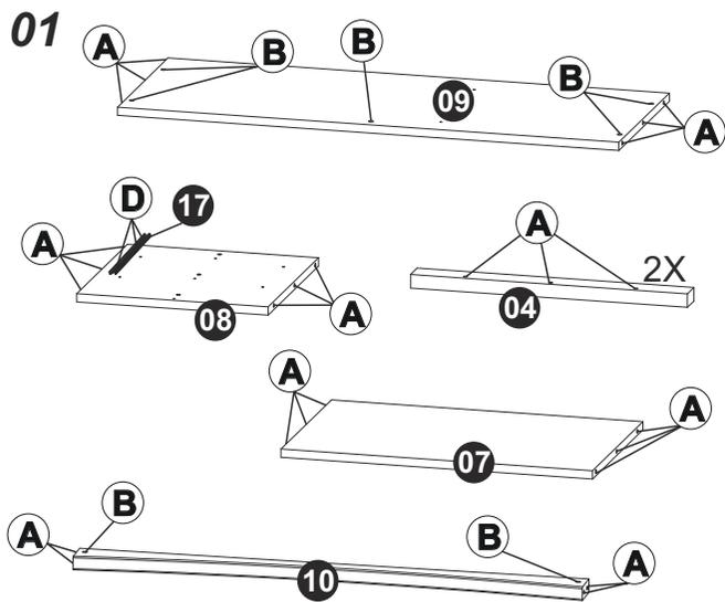
> Montar as cavilhas e os dispositivos trapézios conforme indicado em cada etapa
