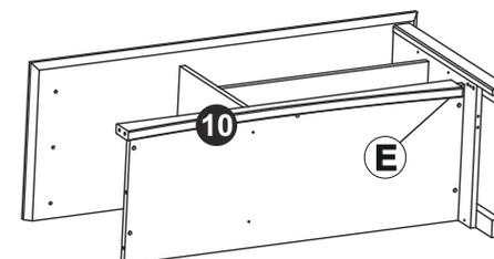
> A peça 10 deverá ser fixada nessa passo, usando o parafuso indicado;
