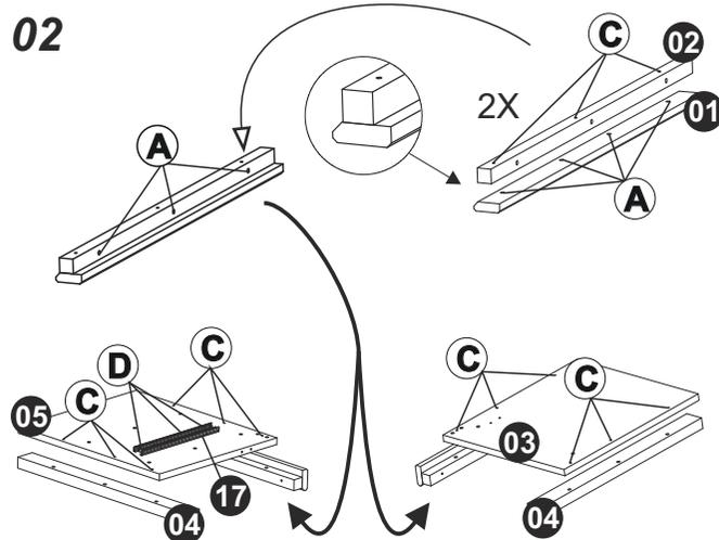
> Montar as peças 01 e 02, observando detalhe;
