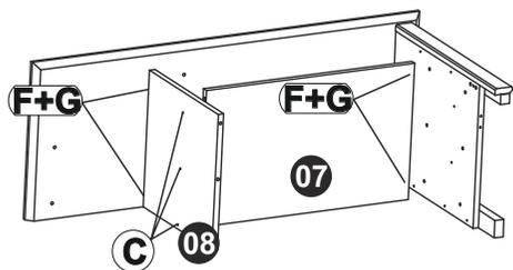
> Montar a peça 07, fixando na lateral com os parafusos indicados.
