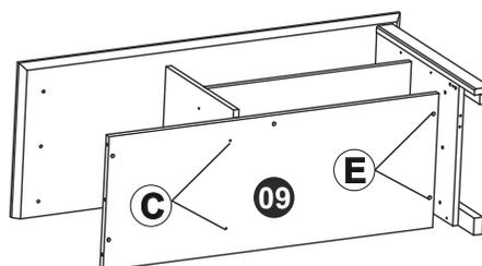
> Fixar a peça 09 na lateral e na divisão usando a ferragem indicada
