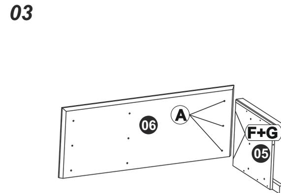
> Montar a peça 06, utilizando-se da ferragem indicada.
