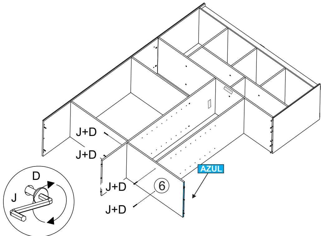
**17** Encaixe a peça (1) na montagem, após fixe com os parafusos (D) usando a chave allen (J) e na extremidade girando os tambores minifix (B).
