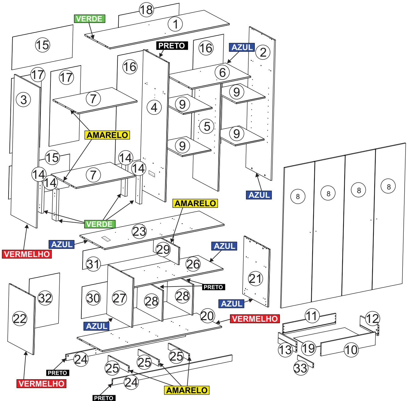
**1** Adicione cola (I) e aplique as cavilhas (F) e (P), os parafusos Minifix (A) e as sapatas (M), conforme desenho.
