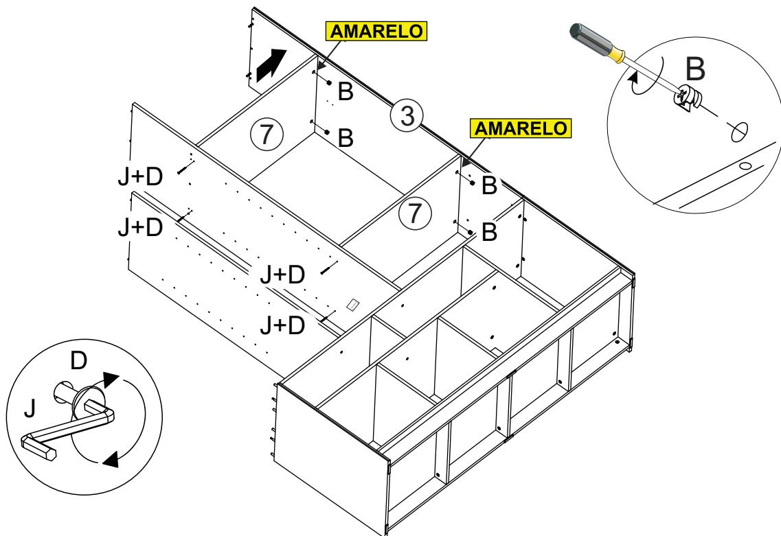
**16** Encaixe a peça (6) na montagem, fixando com os parafusos (D), usando a chave allen (J)
