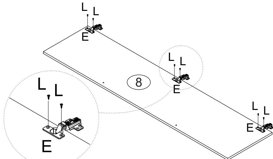
**25** Posicione as portas (8) e fixe as dobradiças nas laterais e divisão, utilizando os parafusos (L), conforme ilustrado.
