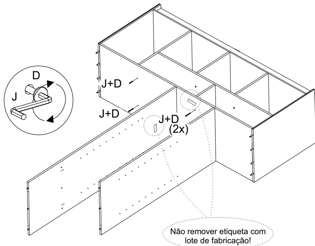
**14** Encaixe a peça (3) na montagem anterior. Fixe girando os tambores minifix (B).
