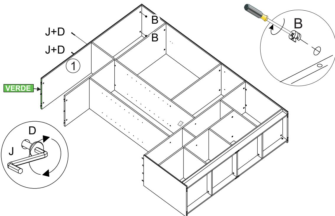
**18** Encaixe a peça (2) na montagem anterior. Fixe girando os tambores minifix (B).
