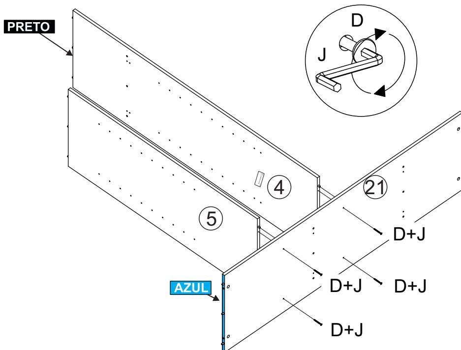
**12** Afaste levemente a lateral (20), encaixe a montagem com a peça (21) e fixe girando os tambores minifix (B).
