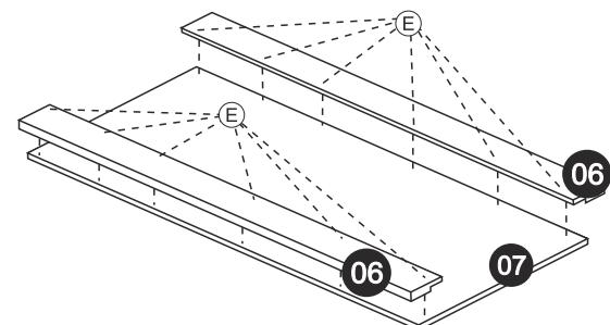
OBS: alinhar a peça com a parte de fora dos pés e após fixar a cantoneira com os parafusos
