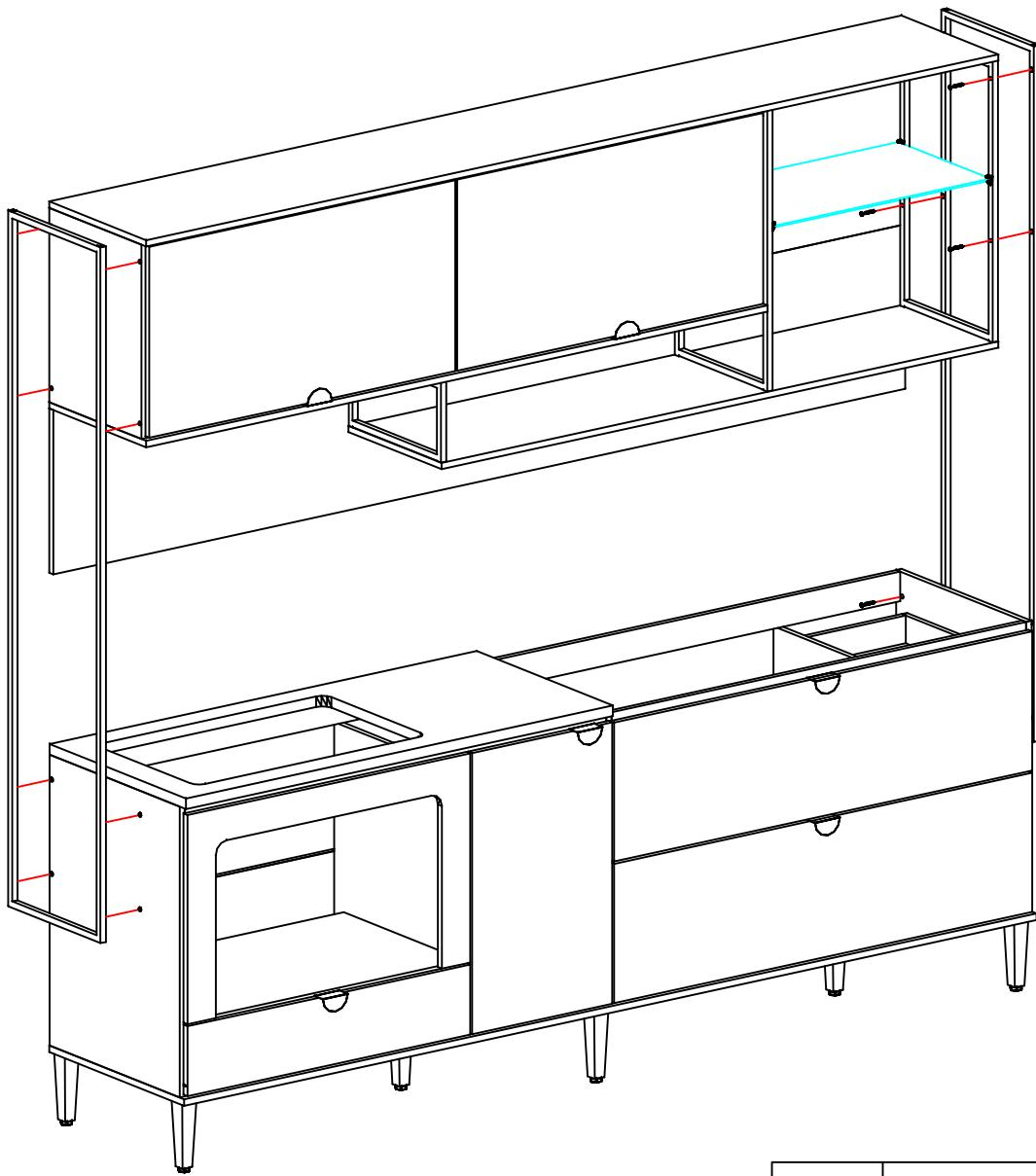
Para fixar as laterais de metal, para união do balcão com o aéreo, será utilizado o parafuso estrutural 1/4 x 20, que acompanha os acessórios do aéreo. Para dar acabamento à cabeça dos parafusos utilize as tampas CPL nas cores indicadas.
