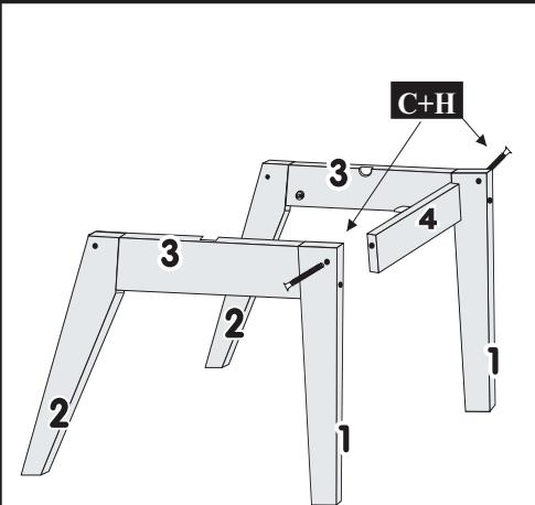
3º - FINALIZAR COM A TRAVA TRASEIRA N°5 UTILIZANDO ANEL FIXADOR + PARAFUSOS 1/4X70 CAB.13mm
