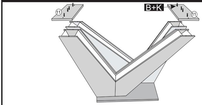
8º - CENTRALIZAR A BASE NO TAMPO USANDO AS SEGUINTE MEDIDAS. FINALIZAR COM CANTONEIRAS 4 FUROS + PARAFUSOS 3,5X14
