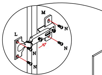
A dobradiça "L" deve ser encaixada no calço "M" e estes colocados com os parafusos "N", observando o procedimento a cima.
