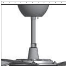
7. Agora ajuste a canopla de teto para ficar rente ao teto e use o parafuso atarrachante 2,9x6,5 para fixa-la.
