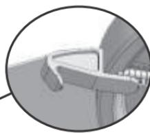
8. Após a colocação das lâmpadas observe que o vidro da luminária é preso por garra, basta encaixar duas garras fixas e puxar a terceira com a mola para fora.
