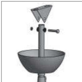
6. Encaixe as borrachas anti-ruido nos furos superior da haste. Coloque o suporte de fixação, alinhando seus furos com o parafuso M-6x30 e PORCA TORNEADA M-6, **FAÇAS AS INSTALAÇÕES NO TETO** e **FAÇA AS INSTALAÇÕES ELÉTRICAS**.
