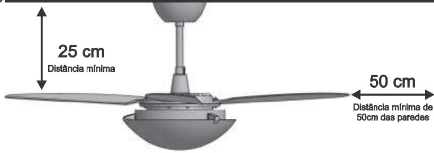
**Obs.: Ao adquirir mais de um ventilador VENTAX10, não misture as pás de uma caixa com as da outra, pois são balanceadas e pesadas para cada aparelho.**
