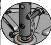
**1.** Fixe as pás ao motor, deixando a pá do lado superior, as porcas sextavadas 3/16" acima e os parafusos 3/16x1" embaixo; Considerando como lado superior, aquele que possui eixo de fixação da haste.
