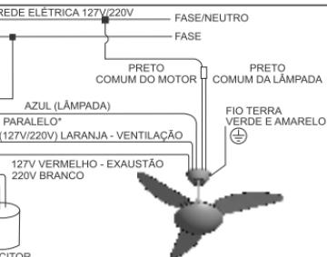
**ATENÇÃO!** Quando não utilizar o controle de parede original, substitua também o capacitor pelo modelo descrito ao lado
