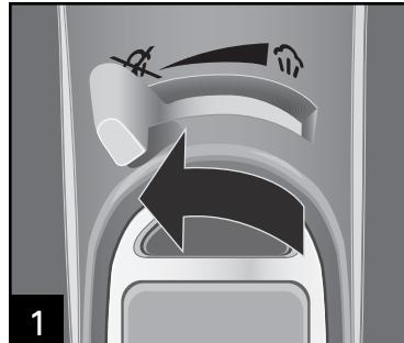
1 Desligue o ferro e coloque a chave Ajuste do Vapor no (sem vapor).
