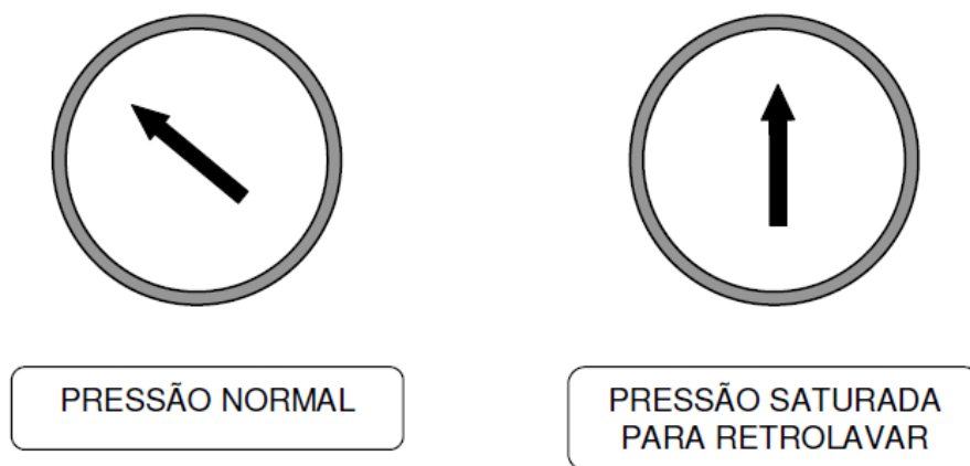
Figura 6 – Posicionamento dos Manômetros
