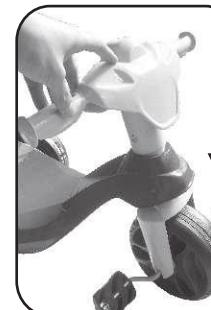
4- Posicione o guidão na extremidade do garfo e pressione até total travamento do conjunto. Observe que o pino do garfo deve encaixar no furo do guidão.
