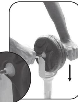
2- Apóie o garfo em uma superfície plana, forrada e firme, pressione o conjunto contra a extremidade de encaixe do garfo até o seu total encaixe.
