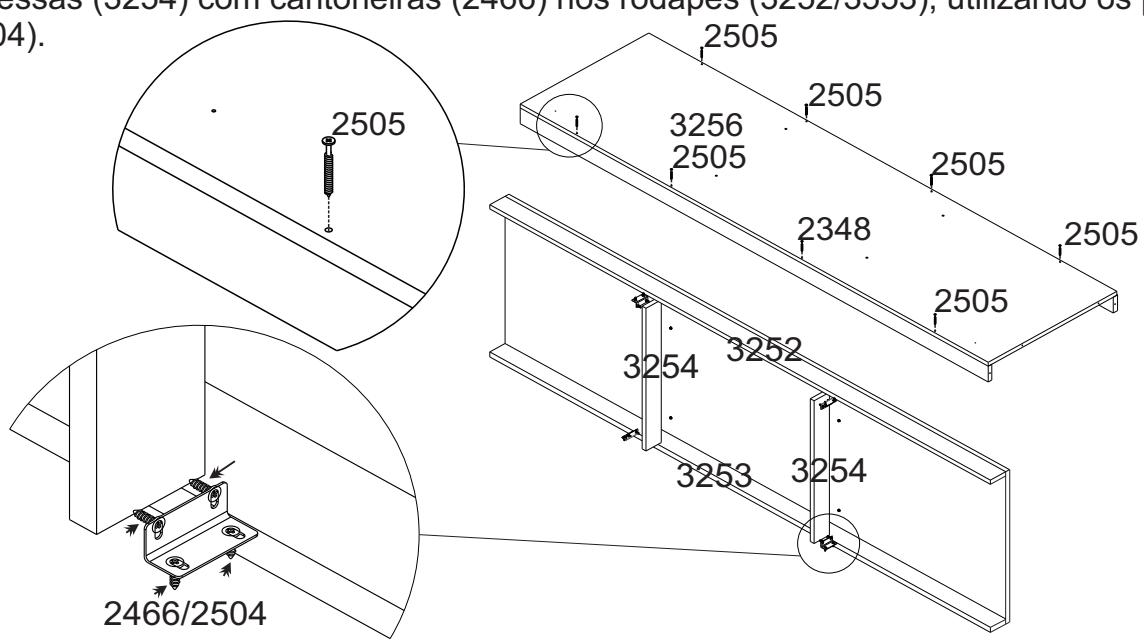
**2** Fixe com parafuso (2525) a lateral direita (3234) na base (3256) e nos rodapés (3252/3253).
