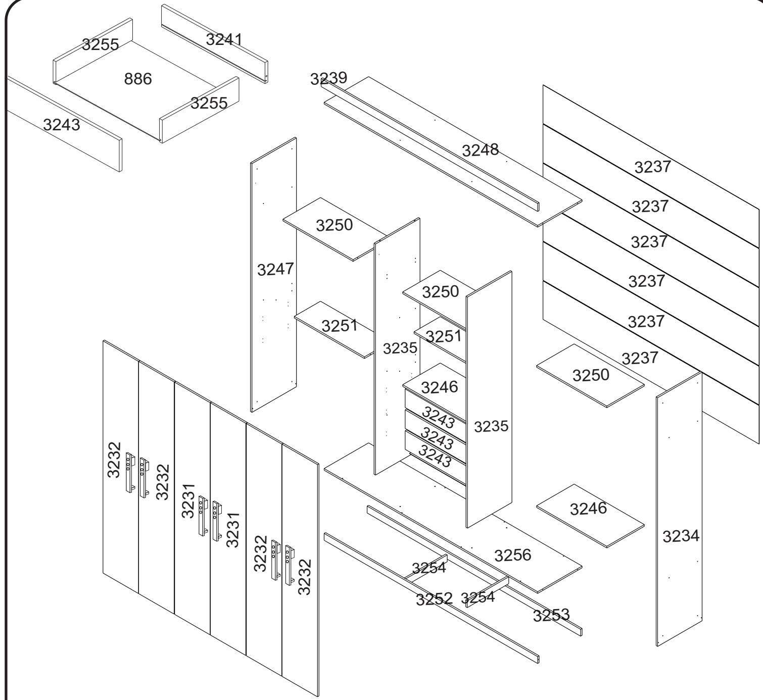
**1** Fixe a base (3256) nos rodapés (3252/3253) com parafuso (2505). Em seguida, fixe as travessas (3254) com cantoneiras (2466) nos rodapés (3252/3553), utilizando os parafusos (2504).
