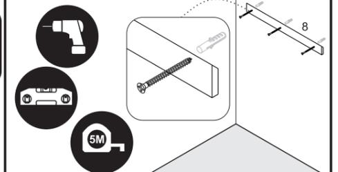
4 - Encaje el panel ensamblado en la pieza 8 y lo alinee correctamente.
