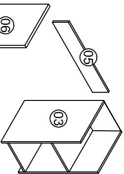
Fixar a peça n°05 na peça 06 com porca cilíndrica e parafuso 5,0 x 60 e na peça 03 com porca cilíndrica e parafuso 4,5 x 50.
