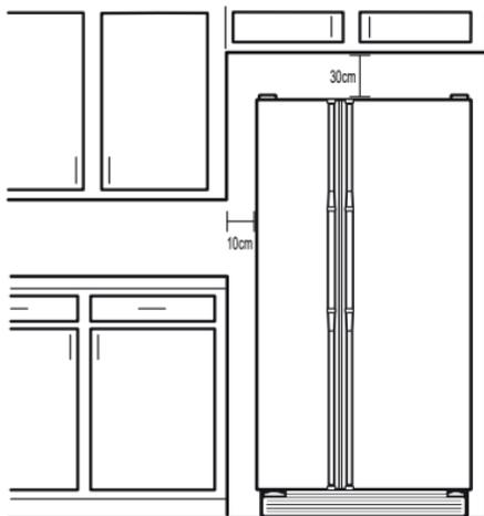
Quando instalar o refrigerador próximo a uma parede fixa, deixe uma distância mínima de 5cm em cada lado para abrir as portas.
